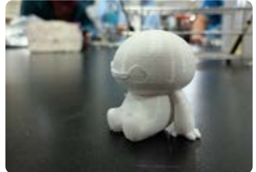
▲將支架拆除後的成品
