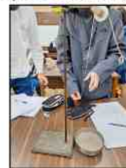
用直尺測量改變砝碼高度 離地45 40 35 30 25公分 圖二十六
